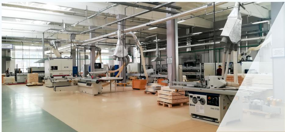
Основное технологическое оборудование имеет числовое программное управление, что дает возможность точного и качественного изготовления продукции. Укомплектование станочного парка нового лыжного производства велось совместно с WINTERSTEIGER (Австрия), WEINIG (Германия), SCM (Италия), PADE (Италия), MIMAKI (Япония) и др.
